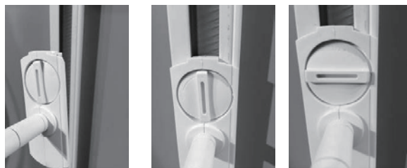
1. Spåret på adaptern i linje med spåret på skenan 2. Sätt i adaptern i skenan 3. Vrid 90° från off till on
