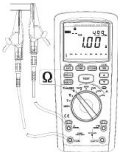
Anslutning vid resistansmätning
