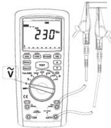
Anslutning vid mätning av växelspänning
