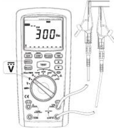
Anslutning vid mätning av likspänning
