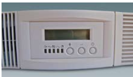
Rackversionens front. VGD-serien med 14 st info-värden har 3 st frontbrytare.
