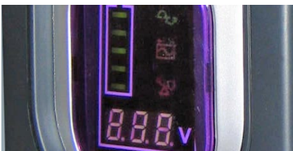
Frontpanel med LCD (laddning/spänning).
